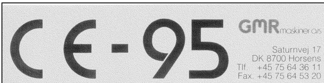
Dieses Zeichen bedeutet, dass die Maschine gemäss der EU-Regeln hergestellt worden ist, und es zeigt das Herstellungsjahr und Adresse der Firma.
