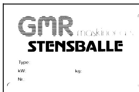
Die Maschine ist mit angeklebten Typenschild/Nummerplatte versehen. Die eingeschlagte Nummer ist für die aktuelle Maschine eindeutig, und die Fabrik kann die Maschine immer zurückfinden, wenn die Nummer angegeben ist. Die Nummerplatte ist auch mit Gewicht in kg
