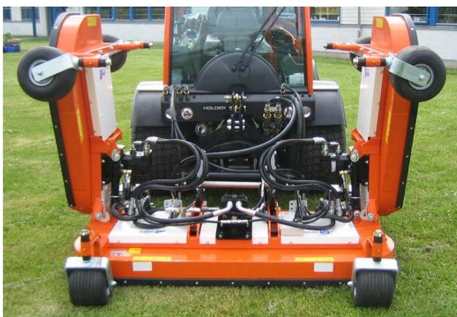
Die Seitenmäher können beim Heben entweder hochgeklappt werden oder in Arbeitsstellung bleiben.
