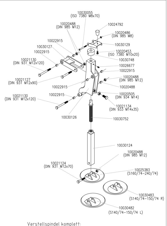
Verstellspindel komplett: 10025922 (ohne Gleitkufen, Halter 10030127, Befestigungsschrauben)
