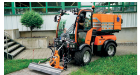
C-Reihe mit Schwemmanlage
