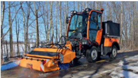
C-Reihe mit Pickup-Sweeper und Soleanlage
