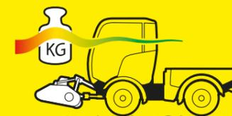
Zum Ausgleich von Lastspitzen bei Transportfahrten ist der Frontkraftheber mit einer hydraulischen Schwingungstilgung versehen.
