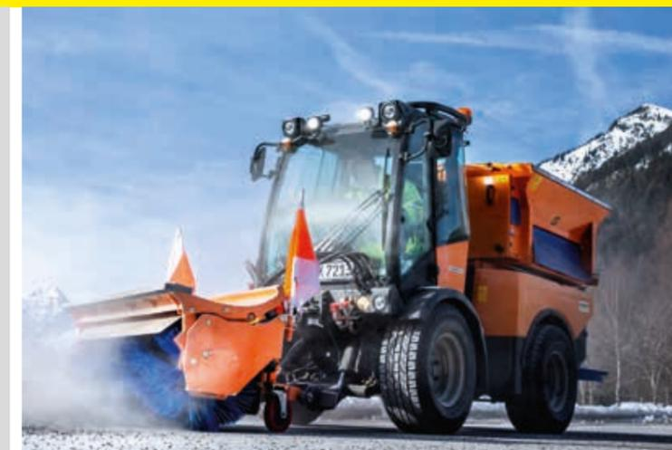
Der Holder S 75 hat all das: Seine Knicklenkung ermöglicht Ihnen agiles, genaues und spurtreues Arbeiten für perfekte Ergebnisse. Der permanente Allradantrieb verteilt die Leistung des 75 PS starken Motors optimal auf alle 4 Räder. Dank einer Breite ab nur 1,31 Meter (bereifungsabhängig) erreichen Sie jeden Winkel Ihres Reviers. Und das Beste: Aus Ihrer Komfortkabine heraus steuern Sie auch härteste Einsätze spielend leicht.
