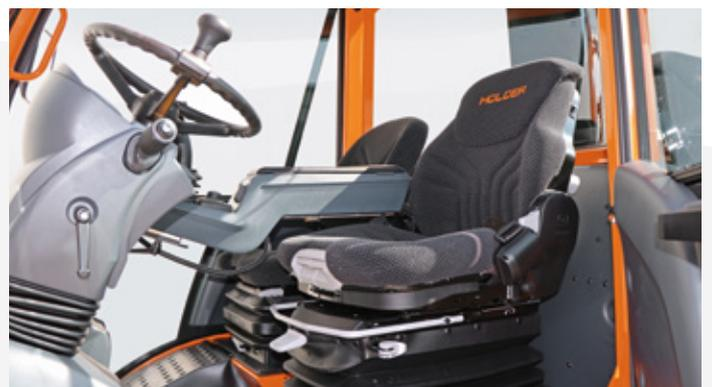
Siège à suspension pneumatique, chauffant et avec accoudoir
