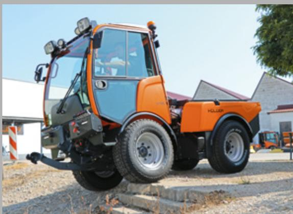
La compensation de charge des roues brevetée assure un contact permanent des quatre roues au sol
