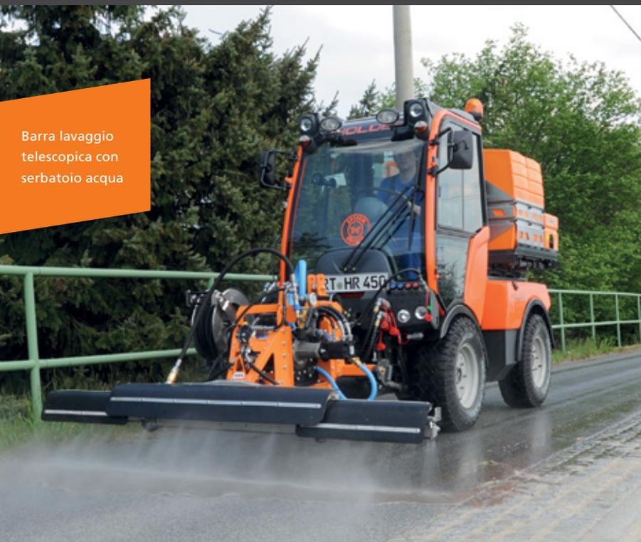
Barra lavaggio telescopica con serbatoio acqua
