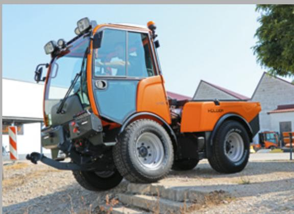
La brevettata compensazione del carico sulle ruote provvede a un contatto permanente di tutte e quattro le ruote con il suolo
