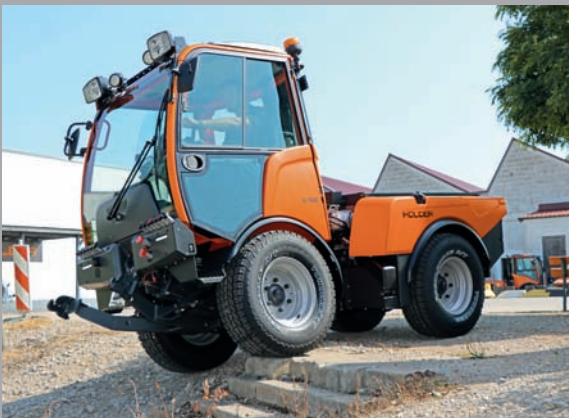
Der patentierte Radlastausgleich sorgt für den permanenten Bodenkontakt aller vier Räder
