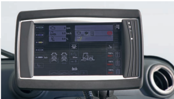
Touch-Display zur Bedienung sämtlicher Hydraulikfunktionen
